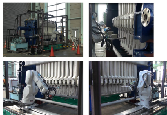
Fig.3 自動土壌除染を行うフィルタープレス装置のろ布自動交換ロボット
