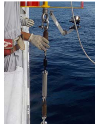
図4 水車運動評価で用いた流速計
