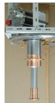
図 5 2 段階 GM 冷凍機（RDK-408D2）
