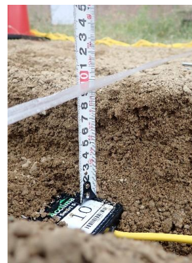
写真-1：圃場実験の様子。3台のマイクロ波放射計で観測し、地中にはセンサーを埋設して計測。
