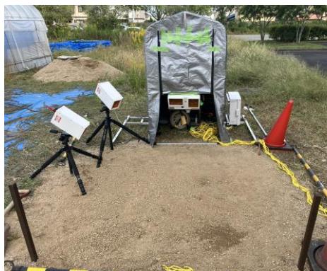
写真-1：圃場実験の様子。3台のマイクロ波放射計で観測し、地中にはセンサーを埋設して計測。
