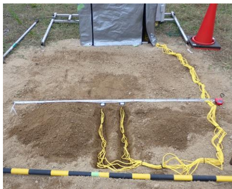
写真-1：圃場実験の様子。3台のマイクロ波放射計で観測し、地中にはセンサーを埋設して計測。
